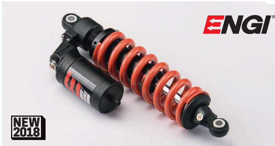
AMORTISSEUR ENGI® RÉGLABLE COMPRESSION DÉTENTE AVEC BONBONNE ENGI® SHOCK ABSORBER ADJUSTABLE COMPRESSION & REBOUND WITH EXTERNAL PIGGY BACK
