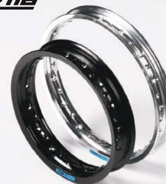
CERCEAU DE ROUE ALU. 7116 M SHAPE ALUMINIUM 7116 M SHAPE RIM
